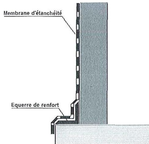
Figure 4 — Cas où l'angle entre mur et semelle n'a pas été chanfreiné
