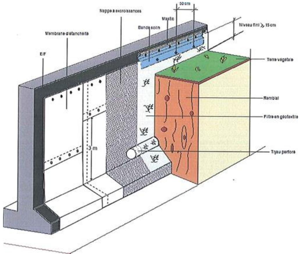
Figure 9 - Mise en œuvre de la protection
