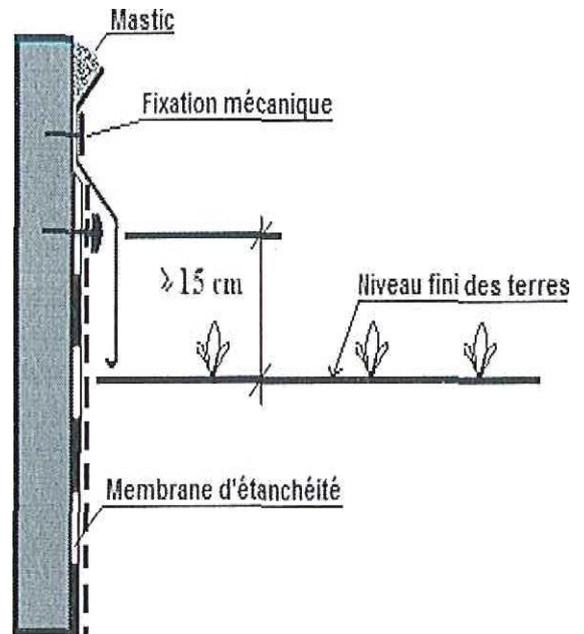
*Figure 6 – Relevé avec profilé métallique filant*
