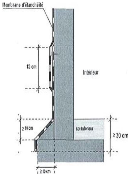
Figure 3a — Niveau bas de l'étanchéité
