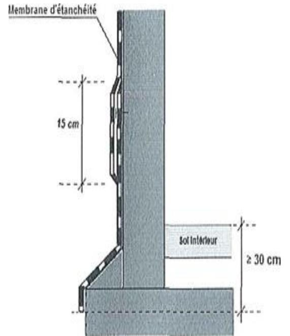
Figure 3b – Niveau bas de l'étanchéité
