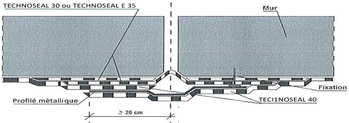
*Figure 8 – Joint de dilatation (cas d'une profondeur d'enfouissement inférieure à 3 m)*
