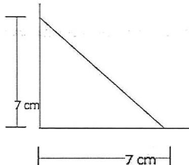
Sur les toitures non isolées avec support en maçonnerie, le chanfrein est réalisé en mortier de Ciment.
